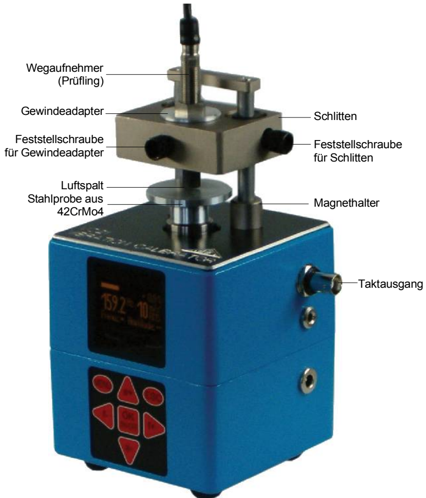
Bild 2: VC21D mit Adapter für Wegaufnehmer und Taktausgang
